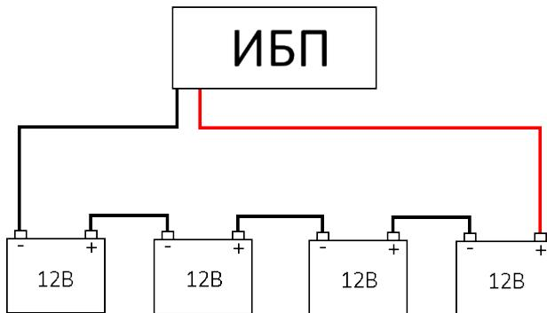
Проверить напряжение комплекта подключаемых к ИБП внешних АКБ. Номинальное напряжение комплекта АКБ должно быть 48 В
