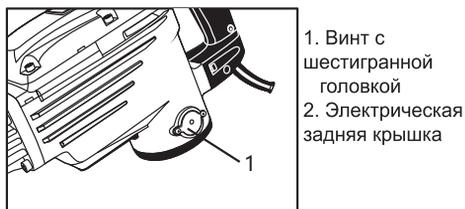
С помощью плоскогубцев поднимите спиральную пружину, снимите медный соединительный винт угольной щетки, установите новую угольную щетку вместо изношенной, снова установите спиральную пружину на угольную щетку, наконечник, затяните винтом медную проволоку угольной щетки.
