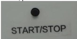
После нажатия данной кнопки прибор начнет работать в максимальном режиме – 2000 Вт. При повторном нажатии кнопки прибор отключится.
