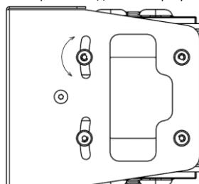
Рисунок 7. Регулировка угла наклона светодиодного модуля.
