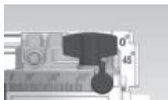
**0°-45°:** Ослабьте переднюю и заднюю фиксирующие ручки, наклоните пилу, следите за стрелкой, указывающей на шкалу, направьте ее под нужным углом, затяните фиксирующие ручки с обеих сторон, чтобы пила была зафиксирована.
