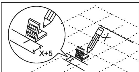
3. Обработайте манжеты и выпуск унитаза технической смазкой и поставьте изделие на заранее выбранное для него место на пол. Обведите унитаз по контуру и отметьте положения установочных отверстий. После этого, уберите унитаз и по отмеченному контуру расположите крепежные уголки на расстоянии  $(x+5 \text{ мм})$  от контура, где  $x$  – толщина керамики.
