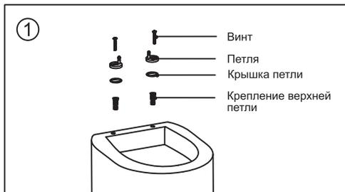
Установка верхнего крепления. Вставьте детали последовательно в керамические отверстия в соответствии с рисунком. Не зажимайте петли сильно, обеспечьте им регулируемое положение.
