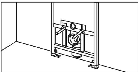
1. Установите, закрепите, отрегулируйте систему подачи воды (систему инсталляции или бачок скрытого монтажа) согласно инструкции по монтажу (поставляется в комплекте с системой подачи воды). Надежно зафиксируйте положение колена металлическими крепежными элементами.
