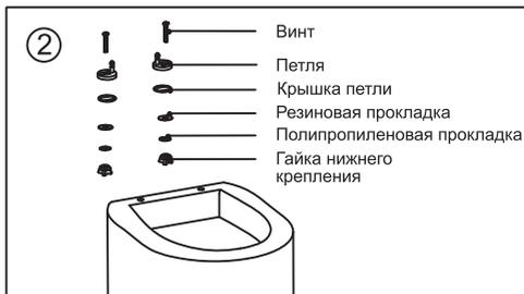
Установка нижнего крепления. Вставьте детали последовательно в керамические отверстия в соответствии с рисунком. Не зажимайте петли сильно, обеспечьте им регулируемое положение.
