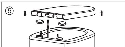
Нажмите защелку для снятия сиденья и крышки. Закрутите винты, вставьте крышки петель. Произведите установку сиденья и крышки на петли.
