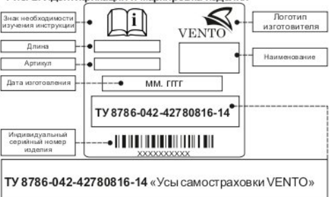
Рис. 2. Идентификация и маркировка изделия
