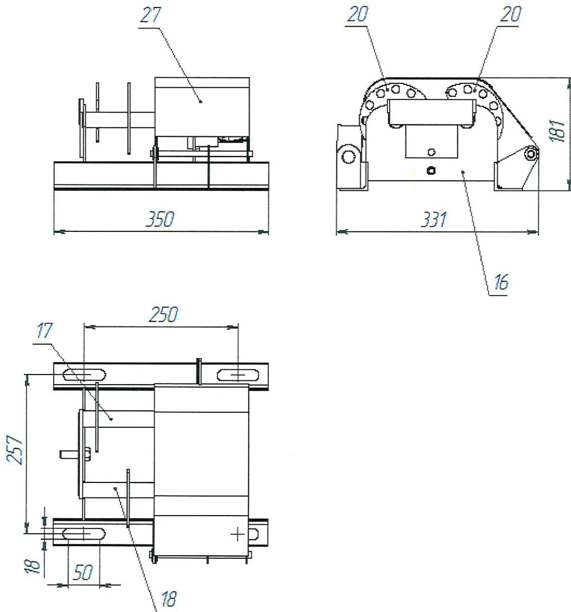
Тяги соединения разъединителя с приводом и расположение отверстий для крепления разъединителя и привода.
