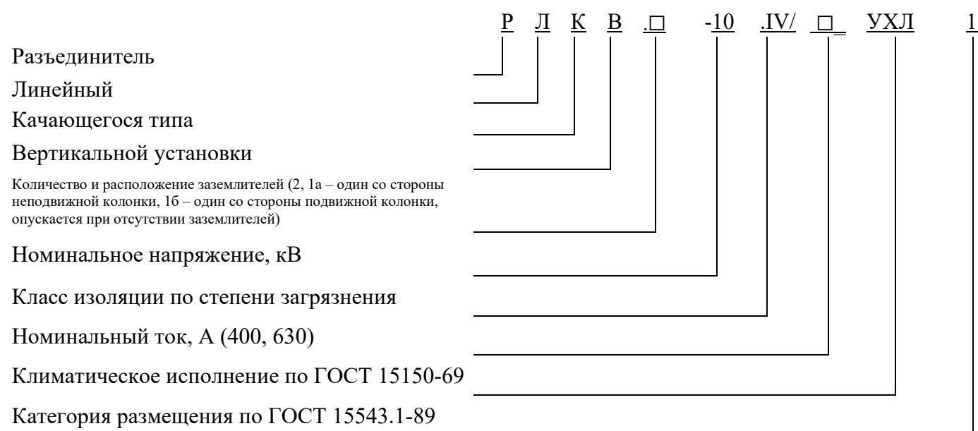
Пример записи при заказе и в других документациях разъединителя с двумя заземлителями, с изоляцией по категории IV на ток 400 А:
