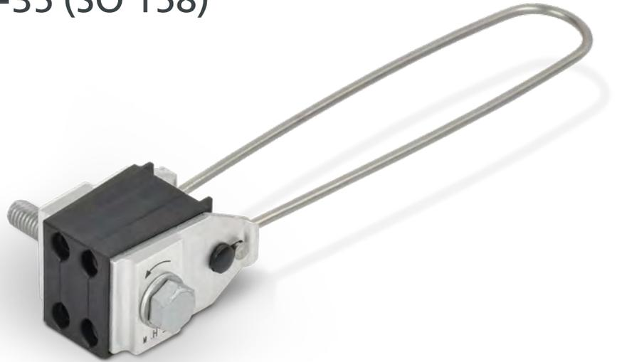
Предназначен для фиксации четырехжильного провода СИП-4 сечением от 16 до 35 мм<sup>2</sup> при выполнении ответвлений от магистральных линий и подключении абонентов.
