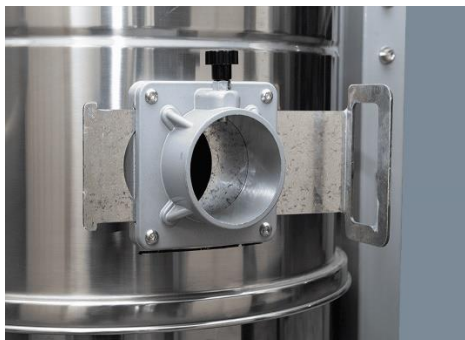
Входное отверстие всасывающей системы с задвижкой
