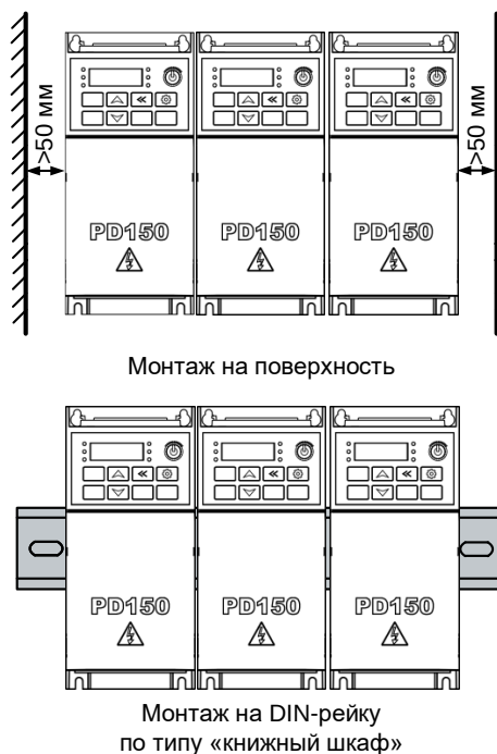
Рисунок 2-6 Установка преобразователя частоты
