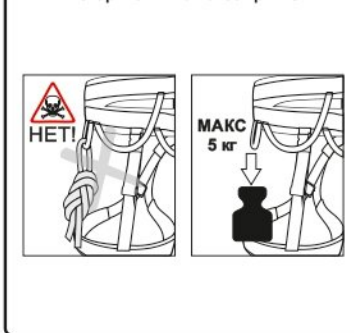
Рис. 13. Развеска инструмента и снаряжения на поясе привязи
