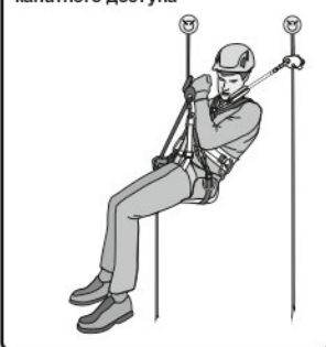
Рис. 12. Пример организации системы канатного доступа
