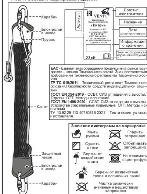
Рис. 1. Состав и маркировка изделия
