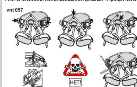
Рис. 8. Способы использования привязи «Профи поясная» vnt 057
