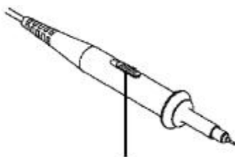
Рис. 3-7: Переключатель затухания зонда
