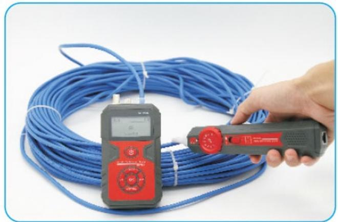
**5.3. Трассировка электрических кабелей**
