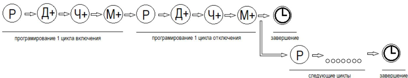
Рисунок 5. Алгоритм программирования циклов вкл/откл.
