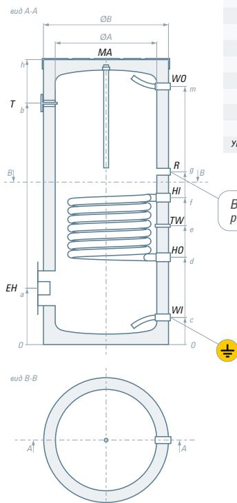
В модели RBF-150 выход рециркуляции располагается ниже входа теплоносителя
