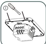
Разобрать корпус: используйте прямую отвертку шириной 3,5 мм. Протяните руку вдоль шва и слегка разорвите ее, чтобы открыть панель.
