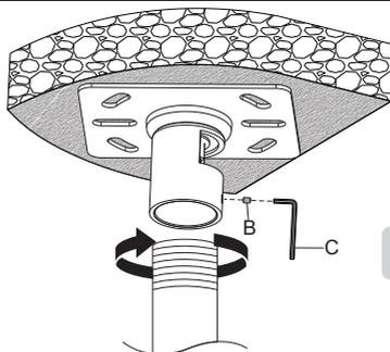
Вкрутить фиксирующий винт для блокировки.
