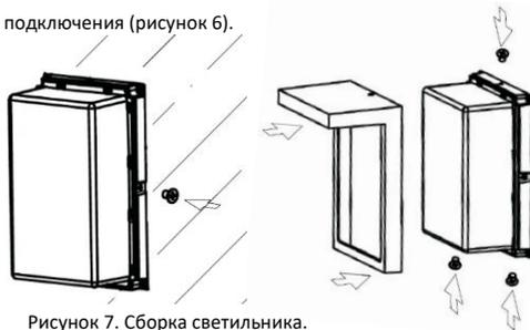
Рисунок 7. Сборка светильника.
