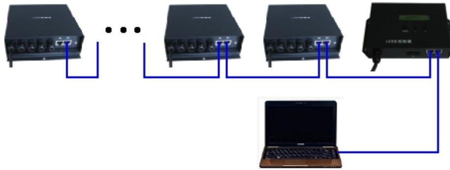
(3). Используйте коммутатор для вывода на многочисленные сетевые интерфейсы, следующее изображение иллюстрирует процесс: беспроводная сетевая карта компьютера передает данные через беспроводной коммутатор, и затем передает данные на H803ТС, можно также использовать карту сетевого кабеля для передачи данных, данные получают несколькими H803ТС, следующее изображение отражает только четыре H803ТС ресивера, можно использовать больше по необходимости.
