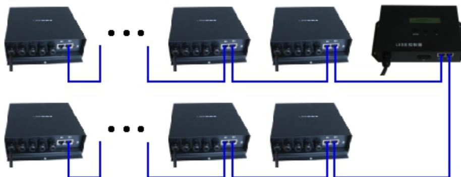
(2). Работа онлайн, H803ТС передает данные с компьютера на подчиненный контроллер, если данные с компьютера не поступают, H803ТС считывает данные с карты памяти и отправит их на подчиненный контроллер автоматически.
