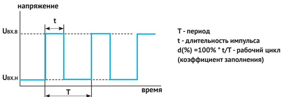
Управление насосом осуществляется с помощью широтно-импульсной модуляции (ШИМ) — сигнала, представляющего собой последовательность импульсов. Контроллер, управляющий насосом, формирует импульсы фиксированной частоты.
