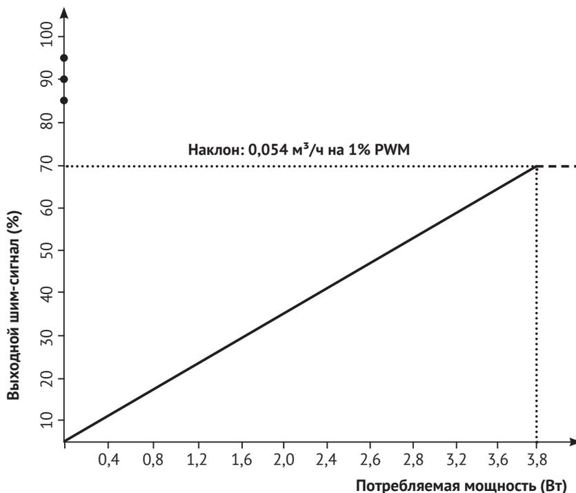
На графике показан характер зависимости: Наклон: 0,054 м³/ч на 1% PWM (пример: при расходе 2,0 м³/ч ШИМ-выход ≈ 37%)
