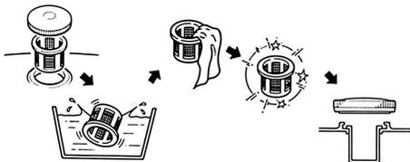
**Рис. 17 Обслуживание фильтра топливного бака**
