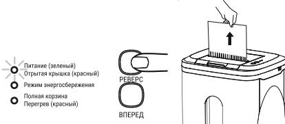
Если замятие бумаги произошло в режиме автоматической подачи, и не может быть устранено, крышку автоподачи можно опустить. В это время загорается индикатор «Открытая крышка», аппарат прекращает работу, вручную очистите застрявшую бумагу, соблюдая требования безопасности.
