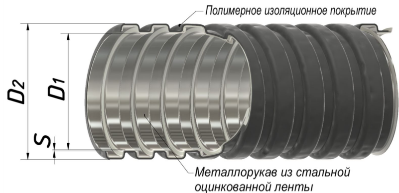
Рисунок 1. Металлорукав типа P3-ЦП нг LS черный
