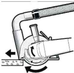
Заметное снижение производительности работы и венец из искр по кругу свидетельствуют о затуплении алмазного отрезного круга. Алмазный отрезной круг можно заточить короткими резами в абразивном материале (напр., в силикатном кирпиче).
