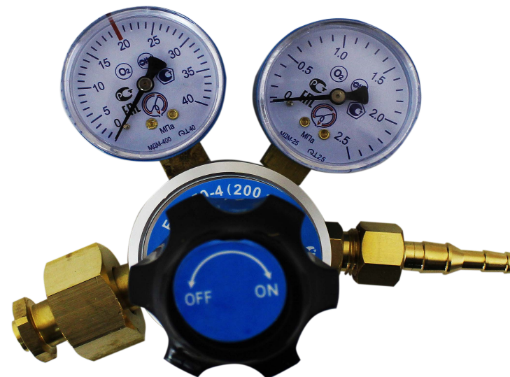
Редуктор баллонный, кислородный, высокого давления, одноступенчатый БКО:
