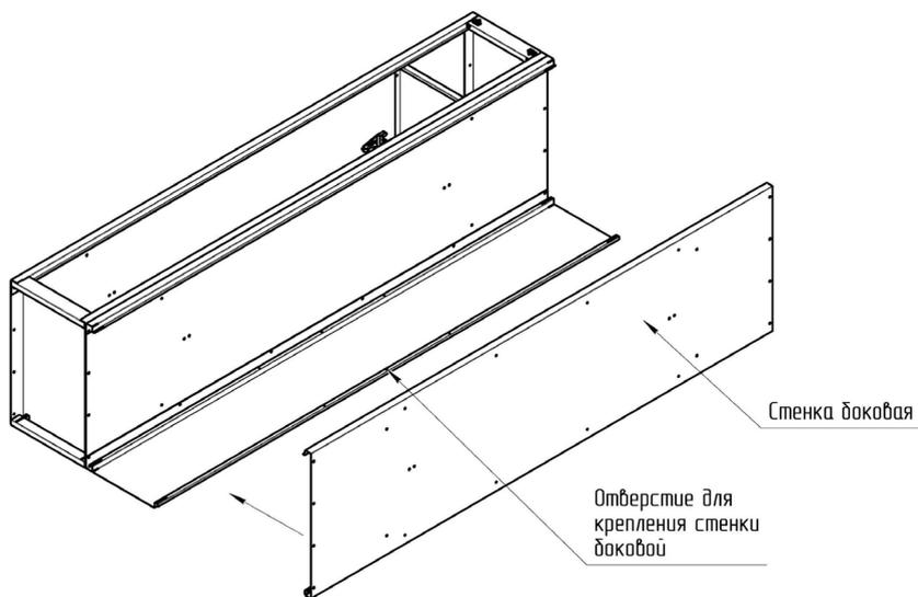
Установить крышу/дно. Приклепать крышу/дно только к одной из боковых стенок (на рис. 6д заштрихована) и задней стенке.
