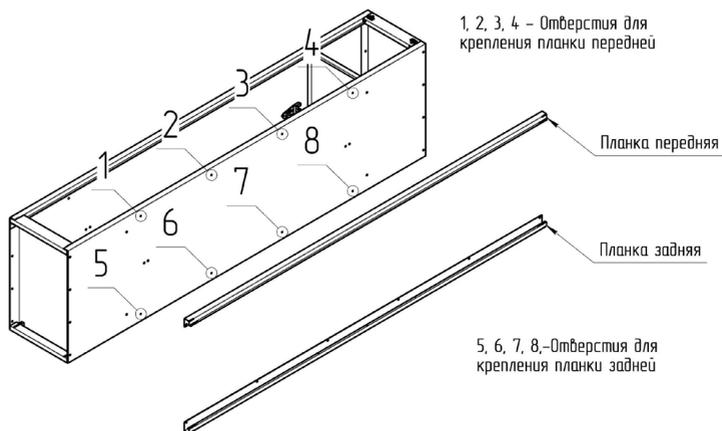
На отгибе задней планки установить заднюю стенку. Приклепать, используя только одно центральное отверстие на отгибе задней стенки.
