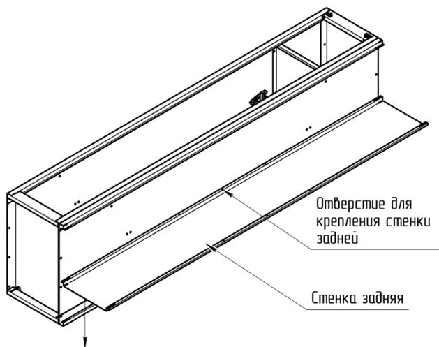
Одной заклепкой приклепать боковую стенку к задней стенке.
