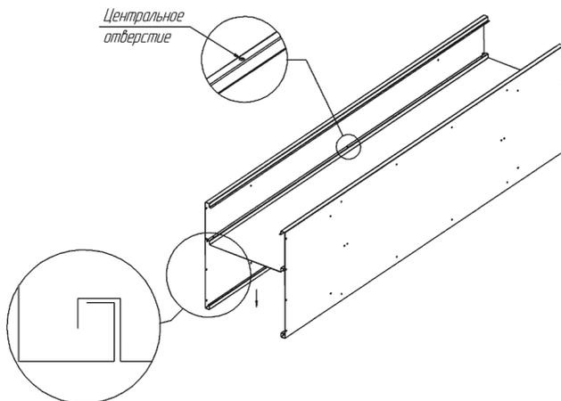
2. Установить крышу/дно. Если вы приобрели односекционный шкаф, приклепать крышу/дно нужно к двум стенкам боковым. Если шкаф состоит из двух и более секций нужно приклепать крышу/дно только к одной из боковых стенок (на рис. 6а заштрихована) и задней стенке.
