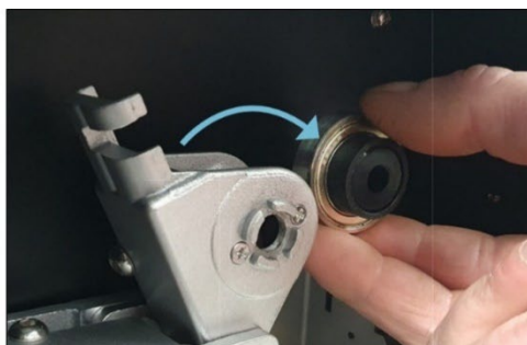
Снимите прижимной ролик с кронштейна
