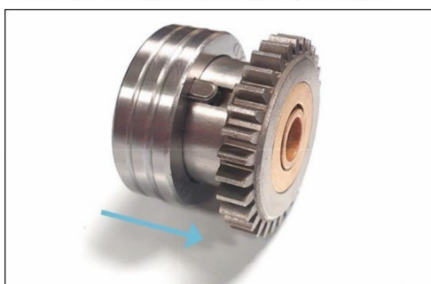
Установите ролик U-типа на шестерёнчатое колесо
