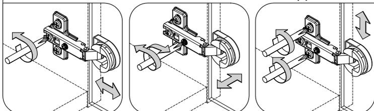
СХЕМА РЕГУЛИРОВКИ ЩИТОВЫХ ДВЕРЕЙ
