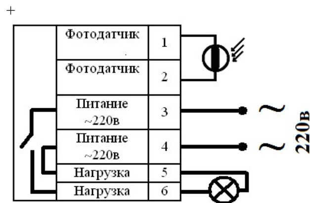
Рис. 3. Типовая схема подключения фотореле к сети 220в.
