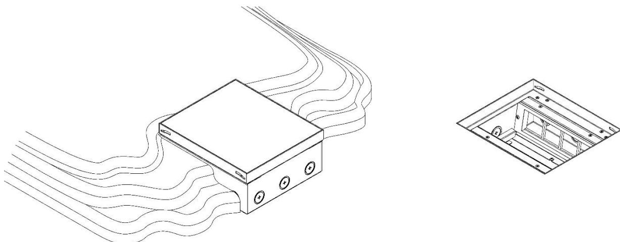
**5.4** Отвинтите суппорта от металлической коробки. Защелкиванием установите в суппортах электроустановочные изделия модульной серии LK45\*. Произведите подключение эзу. Зафиксируйте суппорта в коробке.
