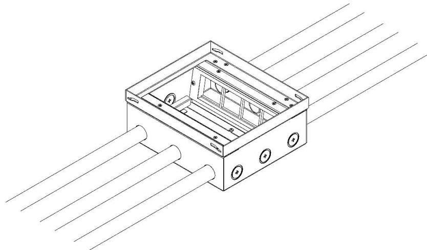
5.3 Установите защитную крышку. Выполните заливку пола. Удалите защитную крышку.
