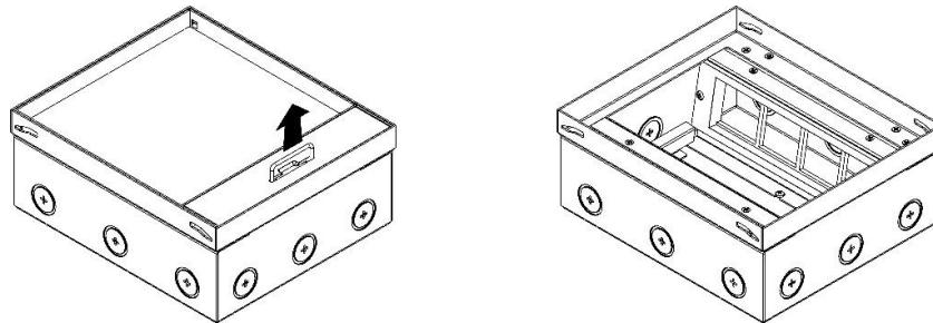
5.2 Подготовьте в коробке необходимые отверстия для ввода кабеля. Зафиксируйте металлическую коробку. Заведите в коробку предварительно проложенные трубы с кабелем.
