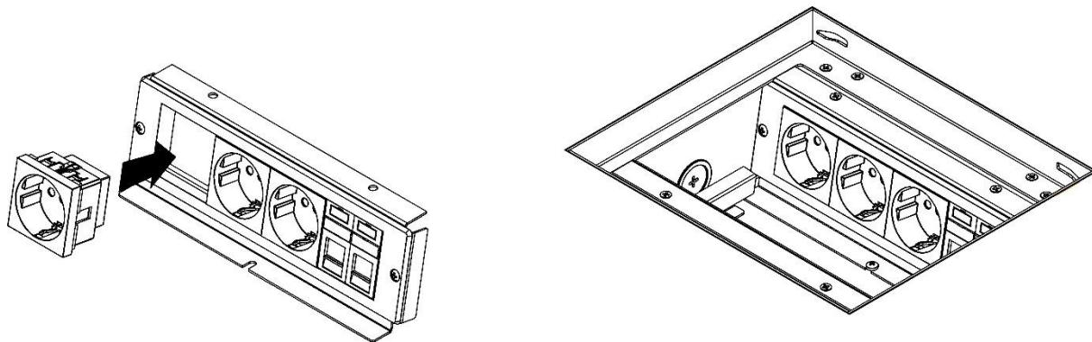
**5.5** Установите крышку люка. В основании люка крышка может монтироваться с двух противоположных сторон. При необходимости замените накладку крышки на материал напольного покрытия. Размер выемки в крышке, мм: 191x181x20.
