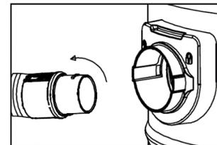
3. Соедините шланг (4) со стальной телескопической трубкой (2)
