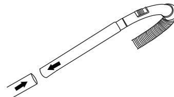
4. Соедините стальную телескопическую трубку с всасывающей щеткой для пола. Вставьте стальную телескопическую трубку во всасывающую щетку для пола, чтобы она вошла в нее очень плотно. Если необходимо заменить одну щетку на другую, снимите используемую щетку и наденьте вместо нее другую.
