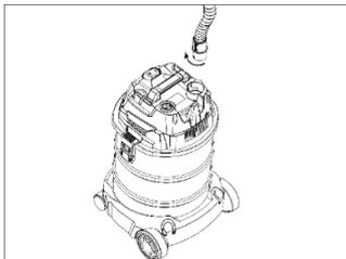
2. При использовании функции обдува вставьте шланг в отверстие для обдува и поверните его по часовой стрелке до фиксации.
