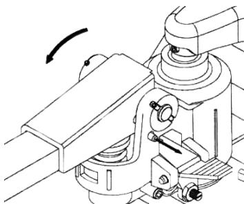
3. Наклоните рычаг так, чтобы сжалась пружина насоса и извлеките страховочный палец
