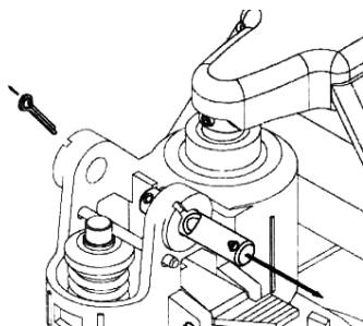
1. Вытащите шплинт из отверстия оси и извлеките ось из посадочного места помпы.
