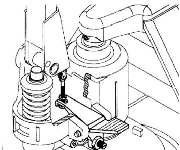
5. Вставьте наконечник цепочки в прорезь уголкового рычага и отрегулируйте гайками цепочки или регулировочным винтом на уголковом рычаге зазор свободного хода уголка в пределах 2-4 мм.
