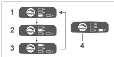
Изменить силу удара можно в три этапа: низкий, средний, высокий. Это позволяет выполнить затяжку, подходящую для работы. При каждом нажатии кнопки количество ударов меняется в три приема.
