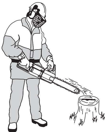
Рисунок 10 — Контроль устройства автоматической смазки режущей гарнитуры
