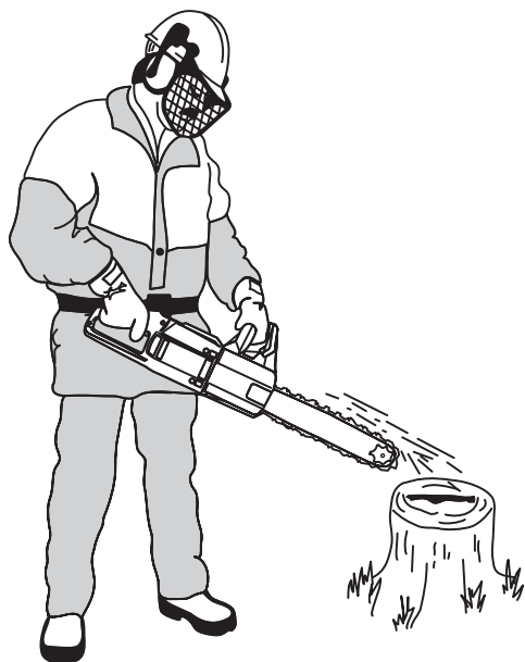
Рисунок 10 — Контроль устройства автоматической смазки режущей гарнитуры
