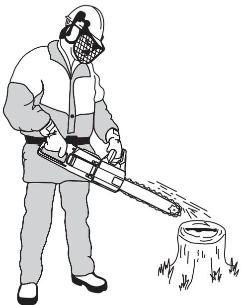
Рисунок 9 — Контроль устройства автоматической смазки режущей гарнитуры
