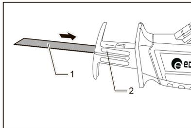
Вставьте пильное полотно в зажим полотна до упора. Гильза зажима полотна плотно вращается и фиксирует полотно сабельной пилы. Убедитесь, что полотно сабельной пилы не может быть извлечено, даже если Вы пытаетесь вытащить его.
