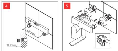
4. Положение эксцентриков должно быть горизонтальным, а расстояние между их центрами должно быть 150мм.
