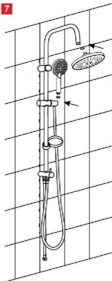
7. Прикрутите верхний душ на штангу, ручной душ к длинному шлангу, второй конец длинного шланга присоедините к отверстию дивертора, расположенному ближе к стене. Короткий шланг, соединяющий смеситель с дивертором, должен быть прикручен к отверстию, расположенному дальше от стены. Если соединить шланги неправильно, система не будет работать исправно, а вода будет идти из обеих леек одновременно.
