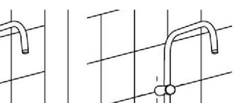
6. Соберите штангу вместе с дивертором (переключателем потока воды между душами). Сначала, через низ штанги, нужно вставить крепление для штанги к стене, потом держатель ручного душа, потом мыльницу и в конце прикрутить дивертор, учитывая то, что гайка, которая вкручивается снизу в штангу, имеет ОБРАТНУЮ резьбу. Выберите место для установки, подбрав
