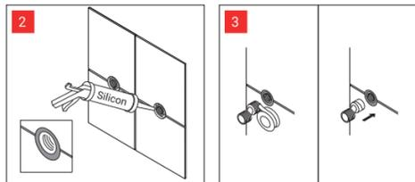
3. Уплотните изоляционным материалом резьбовую часть эксцентриков и вкрутите их в выходы труб системы водоснабжения.
