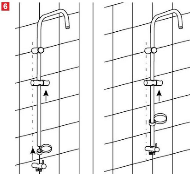
необходимую высоту для комфортного использования. С помощью входящего в комплект крепежа установите штангу с вышеуказанными предметами и дивертором на стену.
