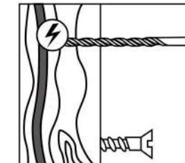
При сверлении стен /заворачивании крепежа в стены предварительно убедитесь в отсутствии в данном месте скрытой проводки
