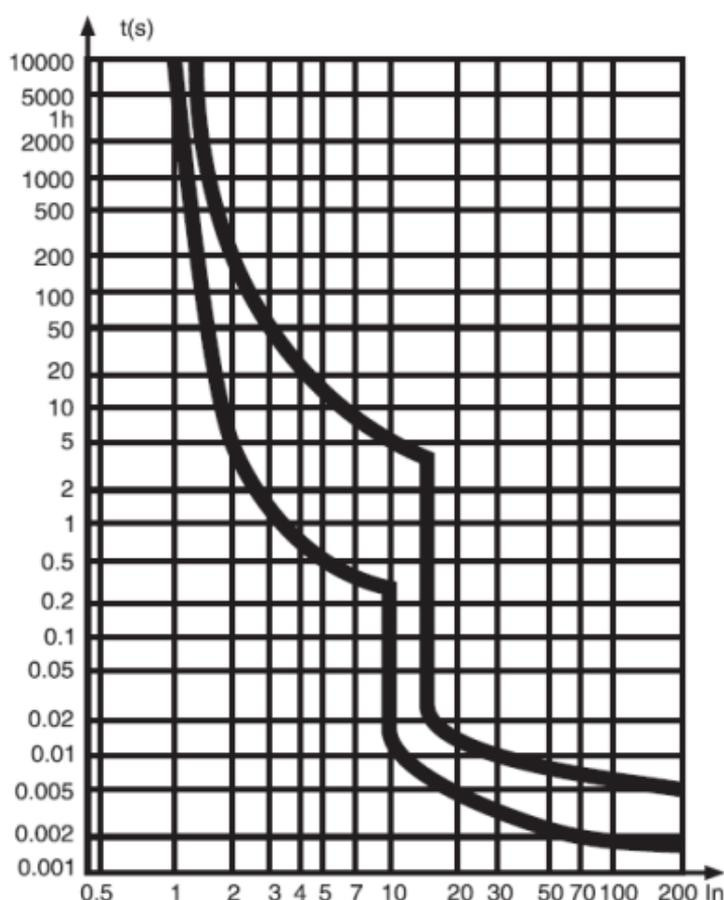
Рис. 3. Время-токовая характеристика D
