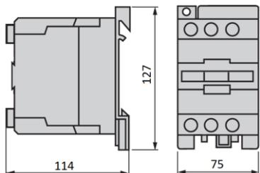
Рисунок 4. Контакторы LC1E40...65
