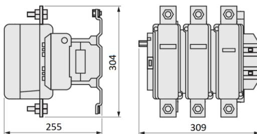
Рисунок 9. Контактор LC1E630
