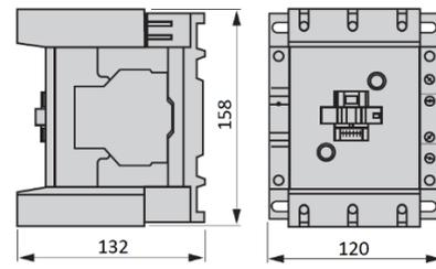
Рисунок 6. Контакторы LC1E120...160
