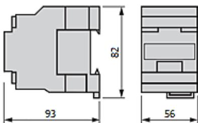
Рисунок 2. Контакторы LC1E25
