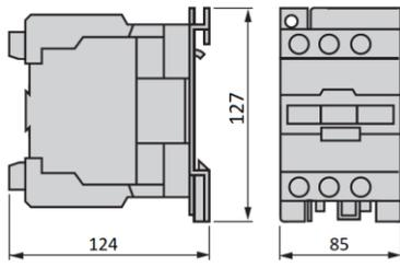
Рисунок 5. Контакторы LC1E80...95
