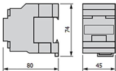
Рисунок 1. Контакторы LC1E06...18
