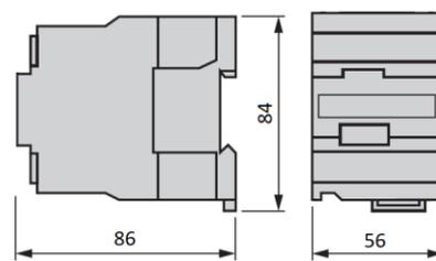
Рисунок 3. Контакторы LC1E32...38
