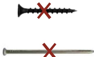
GAH Alberts предостерегает вас от использования в комплекте с соединителями черных фосфатированных саморезов по дереву и гладких строительных гвоздей. Хрупкость черных саморезов не позволяет создавать безопасные несущие конструкции. Зачастую они ломаются в момент вкручивания. Гладкие гвозди под воздействием нагрузок могут начать выходить из отверстий, ослабляя узлы.
