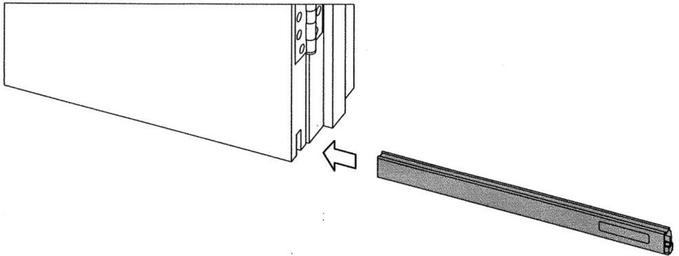
Зафиксировать порог с помощью монтажных кронштейнов, которые прикручиваются крепежными саморезами к торцевым сторонам двери.
