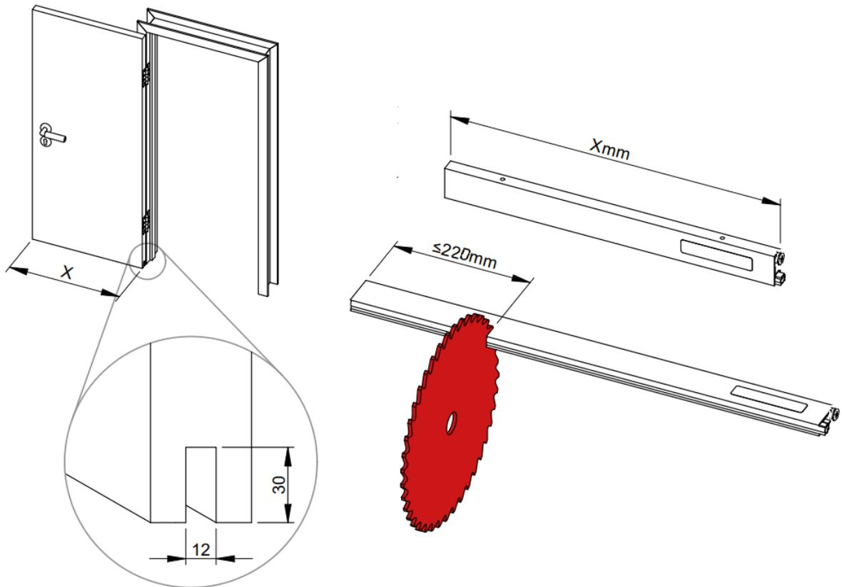
Извлечь уплотнитель из внутреннего зажимного профиля. Отпилить порог до нужной длины (отпилить не более 220 мм). Зачистить напильником торцевую сторону отпила. Вставить уплотнитель в зажимной профиль. Отрезать уплотнитель до нужного размера, но оставить запас с каждой стороны (размер А, В).
