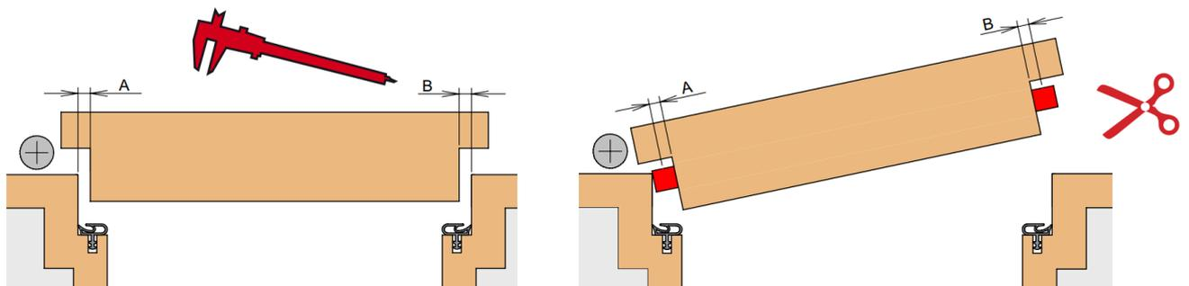
Установить порог в паз на нижнем торце двери.
