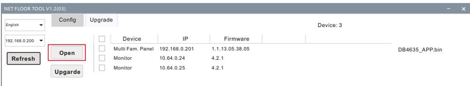
**Шаг 3:** Нажмите **Upgrade** (обновление по), после этого начнется процесс обновления ПО для выбранного устройства. Статус вызывной панели сначала поменяется на **Upgrading** (идет обновление), а по завершении процесса - на **Upgrading OK** (успешно обновлено). Вызывная панель будет автоматически перезагружена. Дождитесь окончания процесса, не отключайте устройство от сети и питания.
