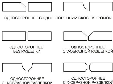
Рис. 6 Виды стыковых соединений
