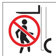
При работе с грузом не устанавливайте груз на концы вилок, не перевозите неустойчивый или плохо размещенный груз во избежание его падения. Будьте осторожны и внимательны при подъеме и опускании груза. При движении с грузом вилы следует опустить как можно ниже. При работе со штабелером никогда не стойте под вилами и не вставайте на них во избежание травм.
