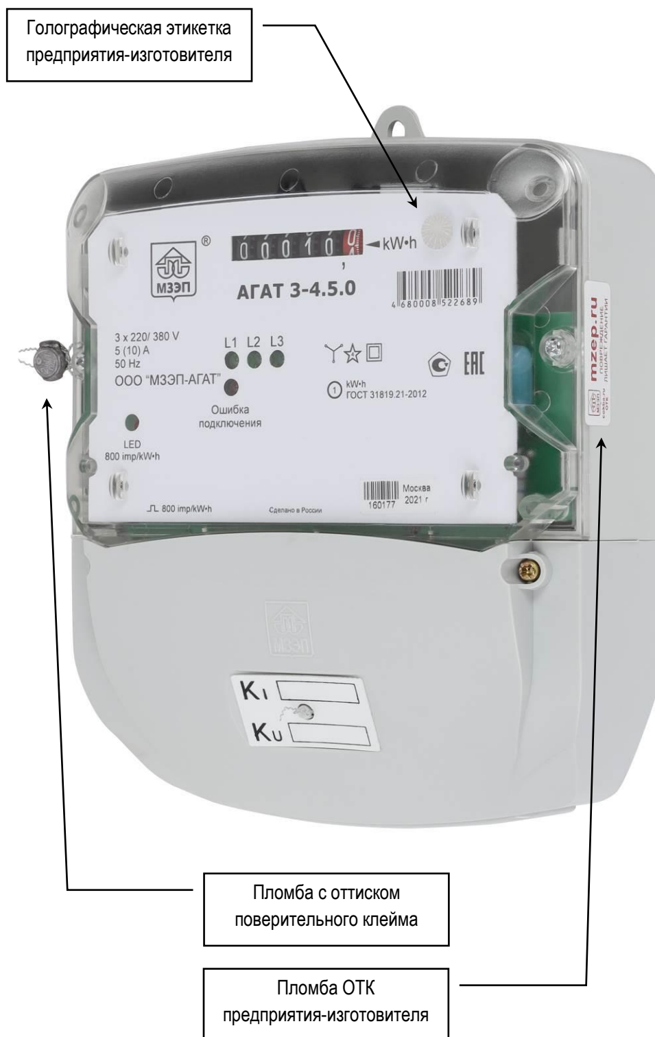
Рисунок 5 - Исполнение корпуса 4. Общий вид счетчика АГАТ 3-4.5.0
